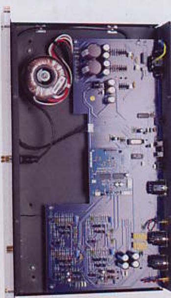
Neu: Digitalektion in SMD-Technik und Modifikationen im Netzteil.
